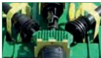
Chaque rotor est protégé contre les chocs par une sécurité à friction
