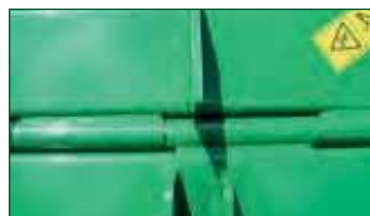
Le pivotement des ailes se fait par une charnière de grand diamètre robuste et facile d'entretien
