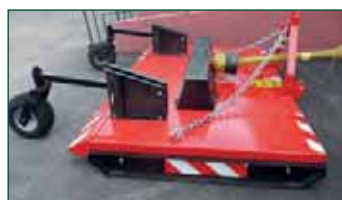
Option paire roues arrière (seulement pour BLSN 2800)
