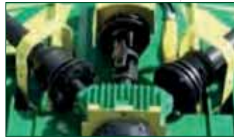
Chaque rotor est protégé contre les chocs par une sécurité
