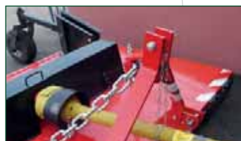
Attelage 3 points flottant (modèle BLSN 2800)
