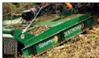
Caisse en tôle ép. 8mm, renforcée
