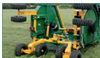
8 roues 6.90/6.00-9 10 plis ø extérieur : 54 cm largeur : 15 cm
