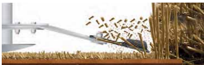
MP3 = rotor équipé de 3 couteaux
