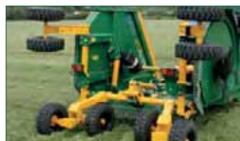
8 roues 6.90/6.00-9 10 plis ø extérieur : 54 cm largeur : 15 cm
