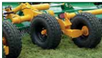
Essieux balanciers avec suspension par boule d'azote sur partie centrale (standard)
