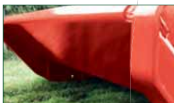
Caisse en tôle ép. 12mm, renforcée
