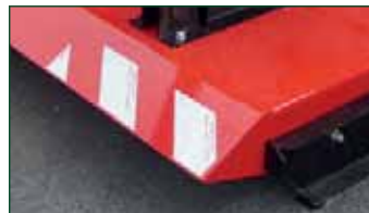
Déflecteurs avant et arrière
