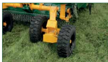
Essieux balanciers avec suspension par boule d'azote sur partie centrale (en option)
