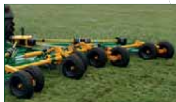
8 roues 10.0/80 x 12 10 plis ø extérieur : 71 cm largeur : 25 cm
