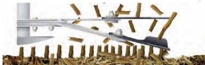
MP6 = rotor équipé de 6 couteaux
