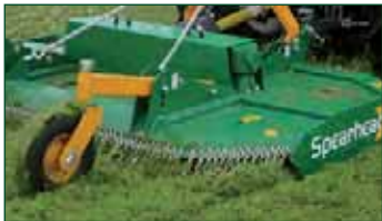
Protections par chaînes à l'avant et à l'arrière de l'appareil
