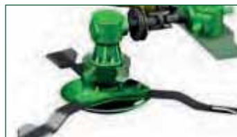
Système d'entraînement Bondioli haute performance pour utilisations en conditions difficiles
